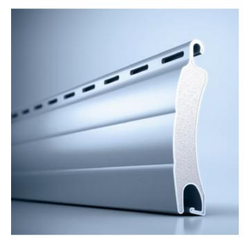
Der hochdichte Schaum verleiht dem filigranen Stab heroal RS 37 RC 2 bei einem Gewicht von 8,0 kg/m² seine extreme Biegefestigkeit und Stabilität. Mit einer Deckbreite von 37 mm und einer Nenndicke von 9,5 mm ist der Stab bis zur Widerstandsklasse RC 2 nach DIN 1627 geprüft und zugelassen. Zusätzlich wurde der heroal RS 37 RC 2 mit der Hagelschlagklasse 7 ausgezeichnet.
