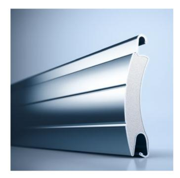
Der aus einer speziellen Edelstahl-Legierung rollgeformte und mit einem sehr belastbaren, hochdichten Schaum ausgefüllte heroal RS 53 RC 3 erfüllt höchste Sicherheitsanforderungen: Windlasten der Widerstandsklasse 6 bei Elementbreiten bis 4.000 mm sowie erhöhte Einbruchhemmung bis RC 3 gemäß DIN 1627. Der heroal RS 53 RC 3 erreicht den maximalen Hagelschutz der Klasse 7.
