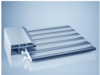
heroal bietet mit zusätzlichen Stegen und einer speziellen Sicherheitsarretierung sowie erhöhten Wandungsstärken und zusätzlichen Kammern für den Einschub von Verstärkungseisen spezielle Führungsschienen für hohe Sicherheitsanforderungen.
