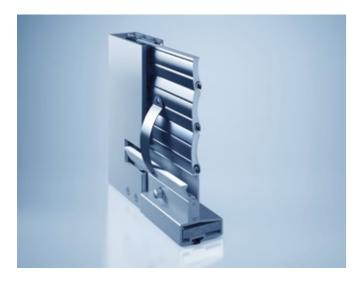
Eine zusätzliche Hochschiebesicherung stellt der in der Endleiste integrierte Kippriegel dar. Dieser fällt bei herabgelassenem Rollladenpanzer in eine Ausklinkung in der Führungsschiene und sorgt für eine zusätzliche Verriegelung.
