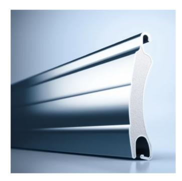
Der aus einer Edelstahl-Legierung rollgeformte Rollladenstab heroal RS 37 RC 3 ist extrem stabil und belastbar. Gefüllt mit einem dauerhaft beständigen hochdichten Schaum, erreichen heroal Edelstahl-Rollladenstäbe die Widerstandsklasse RC 3, nach DIN 1627 geprüft und zugelassen. Der heroal RS 37 RC 3 erreicht den maximalen Hagelschutz der Klasse 7.
